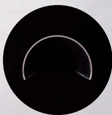
手すり径に合わせた曲げ加工
